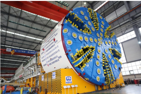
郑州经开区内企业中铁装备自主制造的我国最大直径的泥水平衡盾构机
